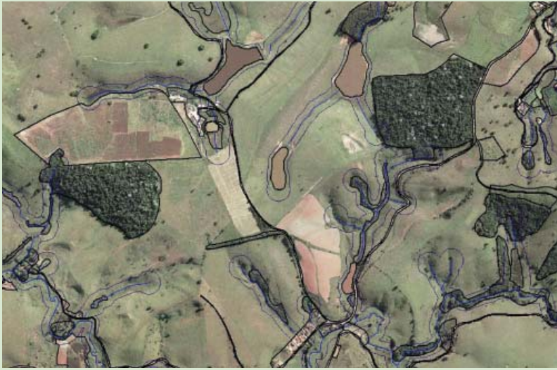
Figura 2.1: Ilustração do processo de fotointerpretação de parte de uma microbacia hidrográfica, utilizando fotografia aérea em escala 1:30.000.
