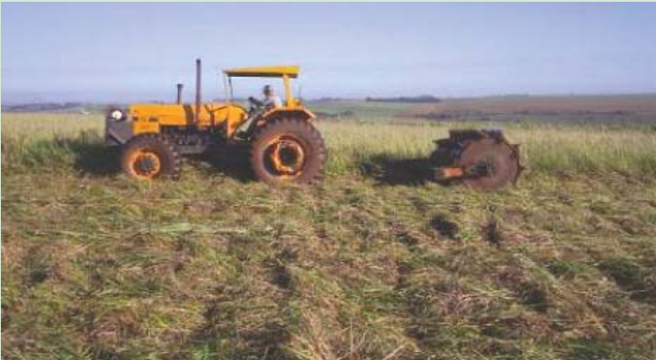
Figuras 6.10: Incorporação de resíduos de cana-de-açúcar com o implemento rolo-faca, Quatá, SP.
