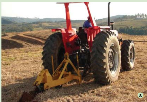
Figura 6.26: Área com o mato já seco, após aplicação de herbicida, sendo preparada para o plantio com um subsolador florestal (A) e técnico medindo a profundidade de subsolação com uma haste de ferro (B).
