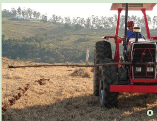
Figura 6.27: Uso de um pedaço de uma vara de madeira “bigode” com uma corrente em sua extremidade para a orientação da subsolação em relação à linha adjacente (A) e disco de corte do subsolador cortando a palhada já seca (B).
