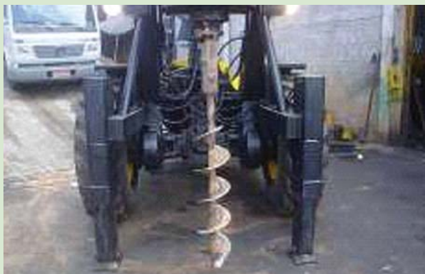
Figura 6.24: Broca Perfuratriz acoplada a um trator.
