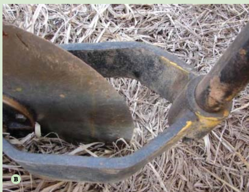
Figura 6.27: Uso de um pedaço de uma vara de madeira “bigode” com uma corrente em sua extremidade para a orientação da subsolação em relação à linha adjacente (A) e disco de corte do subsolador cortando a palhada já seca (B).
