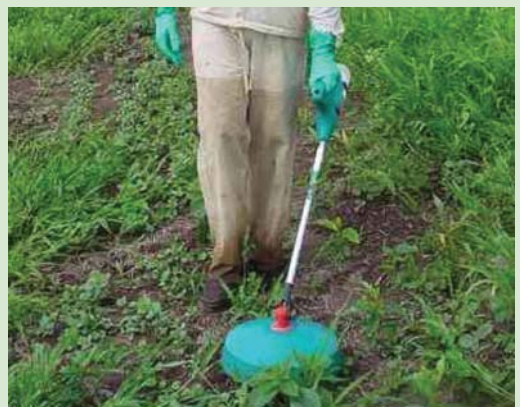
Figura 6.13: Pulverizador de Ultra Baixo Volume que aplica o herbicida puro, dispensando o uso de água.
